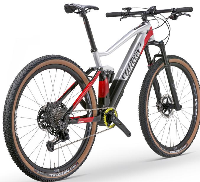
**101FX Hybrid** è costruita con un telaio leggero in carbonio monoscocca, trasmissioni, ruote e allestimenti di alto livello ed una geometria che ricalca quella di **110FX** e **110X**. Il risultato? Una bici da fuoristrada leggera, maneggevole, performante ma con un motore che ti permetterà di ampliare gli orizzonti delle tue uscite.
