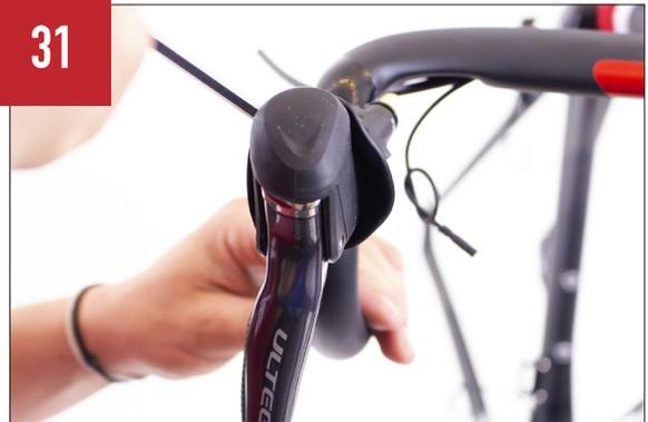
Collegare il comando sinistro al comando destro con un cavo elettronico shimano di lunghezza 700 mm. Fissare il comando destro alla piega manubrio. Collegare il comando destro all'interfaccia shimano EW-RS910 posizionata al termine della piega manubrio con il cavo elettronico shimano di lunghezza 400 mm. Installare il resto dei componenti.
