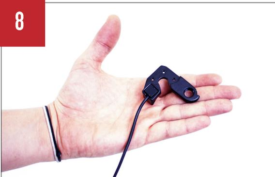
Posizionare il sensore di velocità nel forcellino posteriore.
