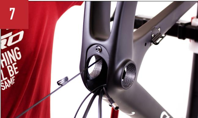
Inserire all'interno del tubo sella il cavo elettronico shimano di lunghezza 1000 mm (sarà collegato alla batteria shimano).
