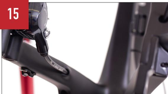
Fissare la pinza freno posteriore al fodero orizzontale.
