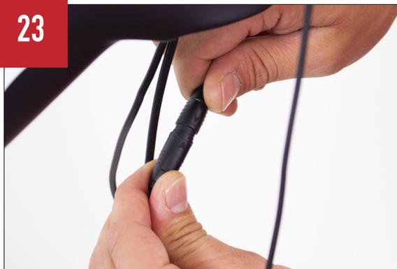
Collegare il connettore dell'iwoc con il cavo corrispondente della batteria. Riporre la connessione all'interno del tubo obliquo, in modo che fuoriesca dal tubo sterzo il solo filo dell'iwoc.
