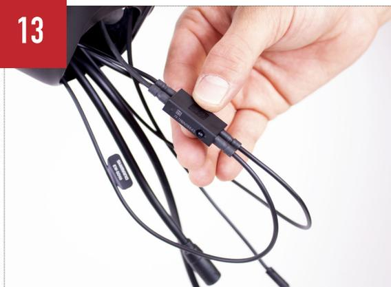
Collegare l'hub shimano SM-JC41 a tutti i cavi elettronici. Posizionare l'hub all'interno del tubo obliquo.
