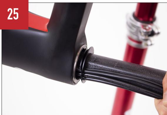
Installare la forcella all'interno del tubo sterzo (con la pinza freno già installata e il cavo idraulico passante per il foro superiore del tubo sterzo).
