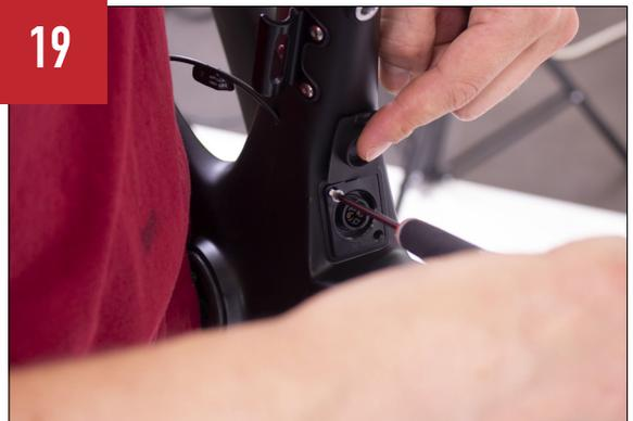
Fissare il charging point con le due viti in dotazione.
