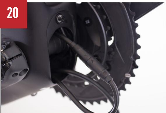
Collegare il cavo del charging point al cavo corrispondente della batteria.
