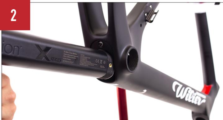
Inserire la batteria all'interno del tubo obliquo, facendola passare nel foro posizionato in corrispondenza del movimento centrale. La batteria deve essere inserita in modo che l'estremità con due cavi terminali sia rivolta verso il tubo sterzo, mentre l'estremità con tre cavi in uscita è rivolta verso il movimento centrale.
