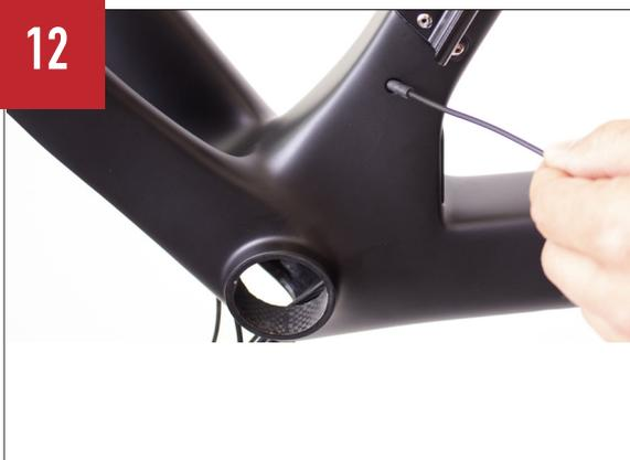
Inserire all'interno del foro deragliatore il cavo elettronico shimano di lunghezza 350 mm (sarà collegato al deragliatore).
