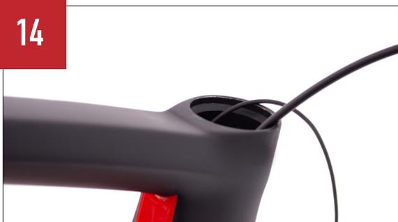
Far passare il cavo idraulico del freno posteriore lungo il telaio, fino ad uscire dal foro superiore del tubo sterzo.
