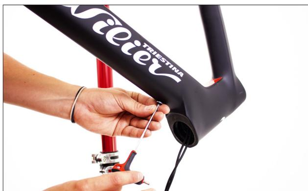
Fissare verticalmente la batteria al tubo obliquo con due viti di lunghezza massima di 8 mm.
