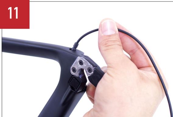
Inserire all'interno del fodero posteriore il cavo elettronico di lunghezza 700 mm (sarà collegato al cambio posteriore).
