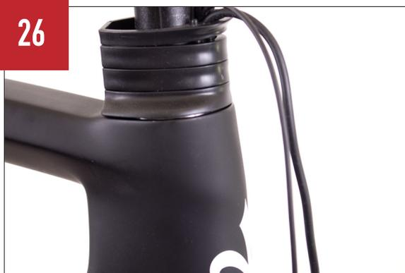
Posizionare la quantità di distanziali che si desidera. **NOTA BENE** devono obbligatoriamente essere installati il distanziale di raccordo tra telaio/distanziali e quello tra distanziali/piega. Dal foro superiore del tubo sterzo, quindi, fuoriescono i due cavi idraulici del freno, il cavo elettronico del gruppo e il cavo iwoc.
