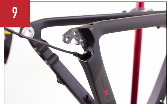
Inserire il cavo del sensore di velocità all'interno del fodero posteriore.
