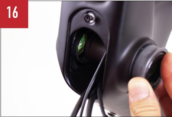
Posizionare il press fit shimano nel foro del movimento centrale.
