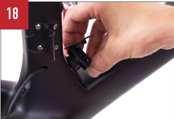
Installare il charging point nel foro del movimento centrale. Fare attenzione al verso di inserimento indicato dalle frecce di posizione.
