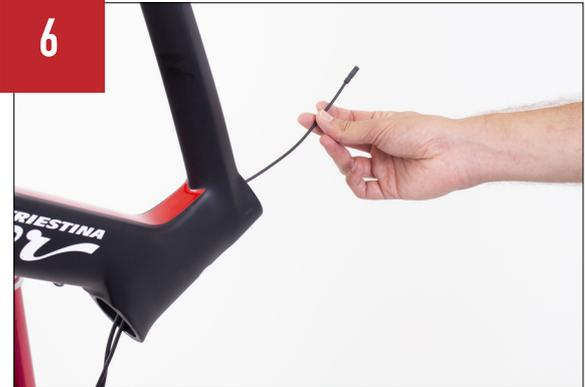
Inserire all'interno del tubo obliquo il cavo elettronico shimano di lunghezza 1200 mm (sarà collegato a una delle leve comando).
