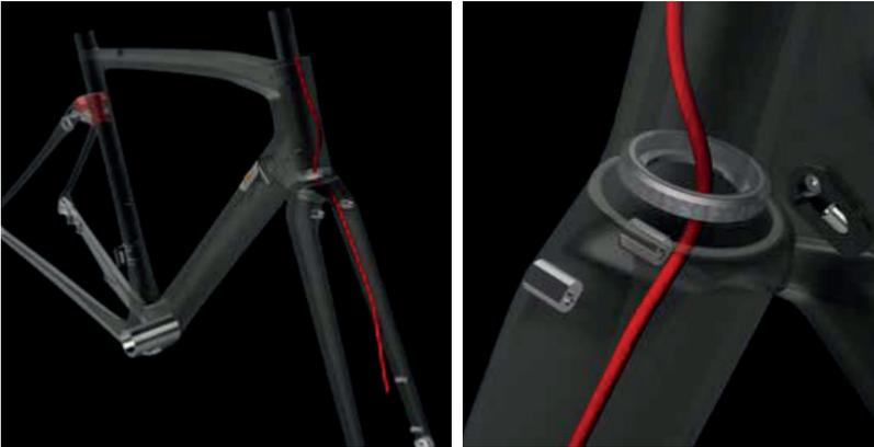
Il tubo obliquo incorpora la placchetta integrata per far scorrere nella maniera più appropriata le guaine / cavi all'interno del tubo stesso. La placchetta può adattarsi a 3 diversi setup della bici: cavi comando esterni con manubrio di tipo tradizionale oppure con comandi elettromeccanici.
