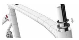
**4d** Insert the top cover (no. 4 in the «Frame» BOM) on the fork sleeve.
