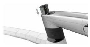
5c Insert the expander adjustment screw (no. 6 in the «Frame» BOM) in the expander (no. 5 in the «Frame» BOM).
