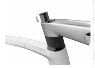
Insert the expander adjustment screw (no. 6 in the **3c** «Frame» BOM) in the expander (no. 5 in the «Frame» BOM).
