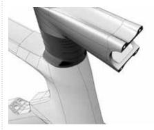
Insert the expander (no. 5 in the «Frame» BOM) in the 2i fork sleeve.
