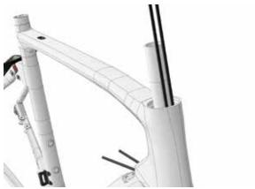
Insert the top bearing (no. 3 in the «Frame» BOM) on **2d** the fork sleeve.
