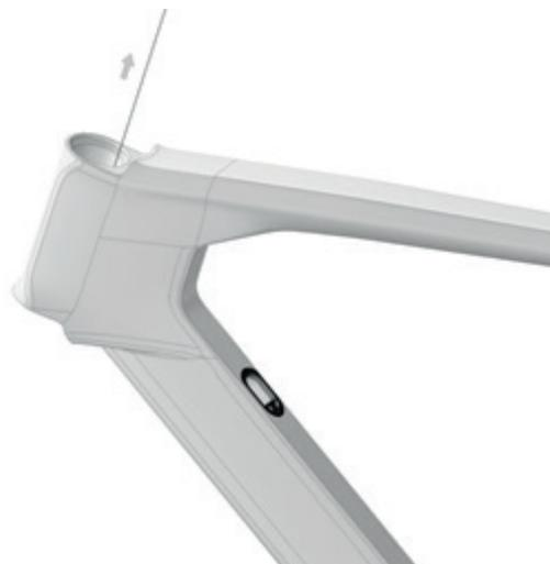
Inserire la guaina del cavo freno posteriore nella guida cavi in gomma. Tirare il cavo freno posteriore dal tubo sterzo in modo da far uscire un'estremità della guaina
