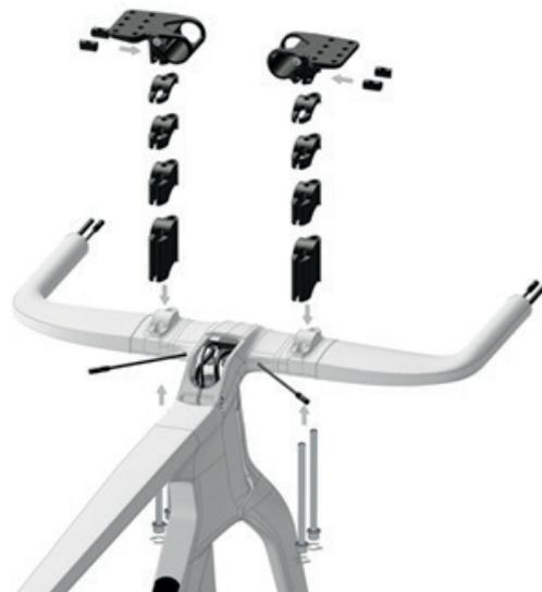
Inserire barre aero nei supporti dei poggia gomiti, tenendole in posizione avanzata in modo da riuscire a inserire i cavi elettronici dai fori posteriori e farli uscire da quelli anteriori. Connettere i cavi elettronici ai comandi SW-RS9160, quindi inserire i comandi all'interno delle barre aero. I cavi elettronici possono essere integrati con i distanziali del poggia gomiti.
