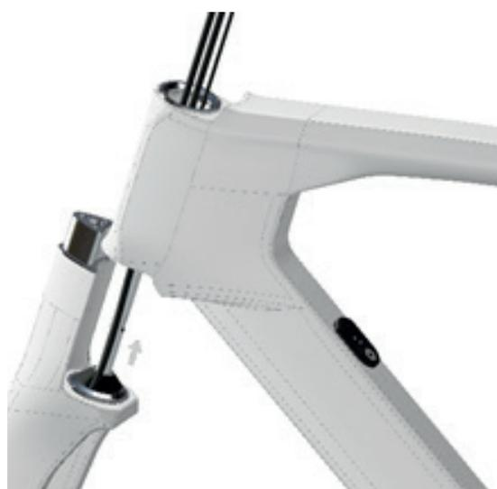
Inserire le guaine dei cavi freno nelle asole dello steerer, sui due fori più larghi, senza intrecciarle. Inserire il connettore elettronico nel foro posteriore laterale dello steerer. Appoggiare lo steerer sul cuscinetto superiore. Regolare il dado di regolazione affinché lo sterzo giri senza giochi con la coppia di serraggio adeguata.
