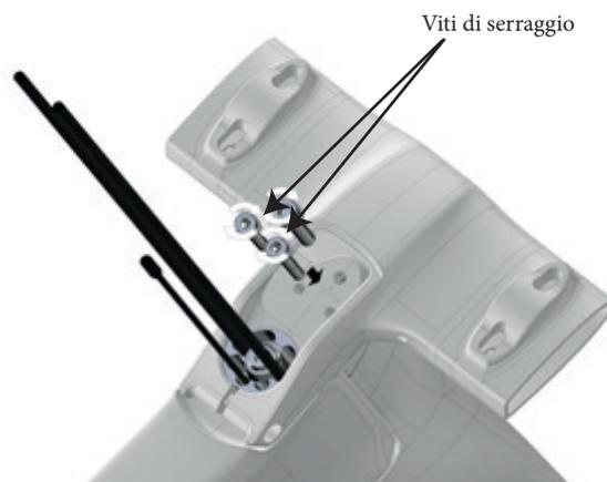
Inserire la vite di fissaggio trasversale, la relativa rondella e il rivetto nell'attacco manubrio.
