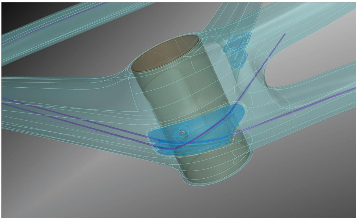
I cavi di comando della trasmissione entrano nel tubo obliquo ma non saranno incrociati all'interno del tubo obliquo, bensì nella nuova guida cavo posizionata sotto la scatola del movimento centrale.
