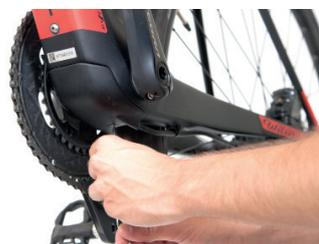
2. Scollegare il cavo motore con quello della batteria; seguire le frecce che si trovano nel punto di inserimento. Togliere le clips che fissano il cavo al tubo del carro.
