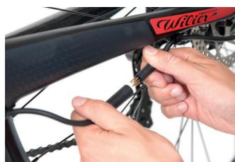
3. Scollegare il cavo batteria dal cavo del PAS sensor. Attenzione a rimuovere adeguatamente i due cavi, altrimenti si rischia di danneggiare i pin all'interno del connettore.
