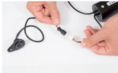
7. Proteggere i connettori della batteria con dello scotch carta, in modo da non danneggiarli durante le operazioni di smontaggio.
