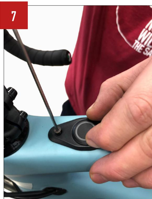
Positionieren Sie den iWoc-Schaltknopf auf das Oberrohr wieder und befestigen Sie ihn mit der Befestigungsschraube.
