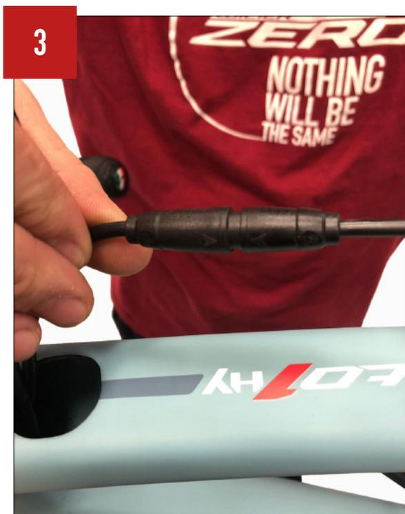
Verbinden Sie die Akku-Anschlussstelle mit der entsprechenden Anschlussstelle des ANT+-Umbausatzes.
