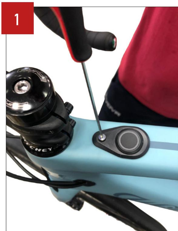
Entfernen Sie die iWoc- Befestigungsschraube aus dem Oberrohr und entfernen Sie den Schaltknopf.
