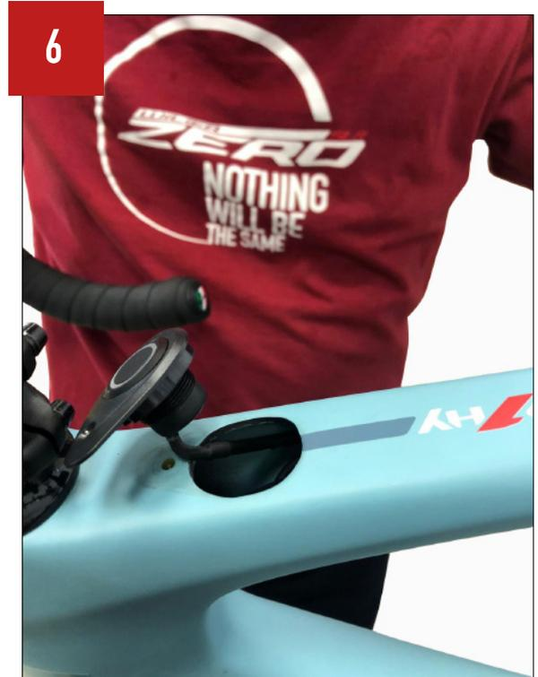
(5+6) Insertar las conexiones dentro del tubo superior. Recubrir las conexiones con material plástico para evitar posibles ruidos.
