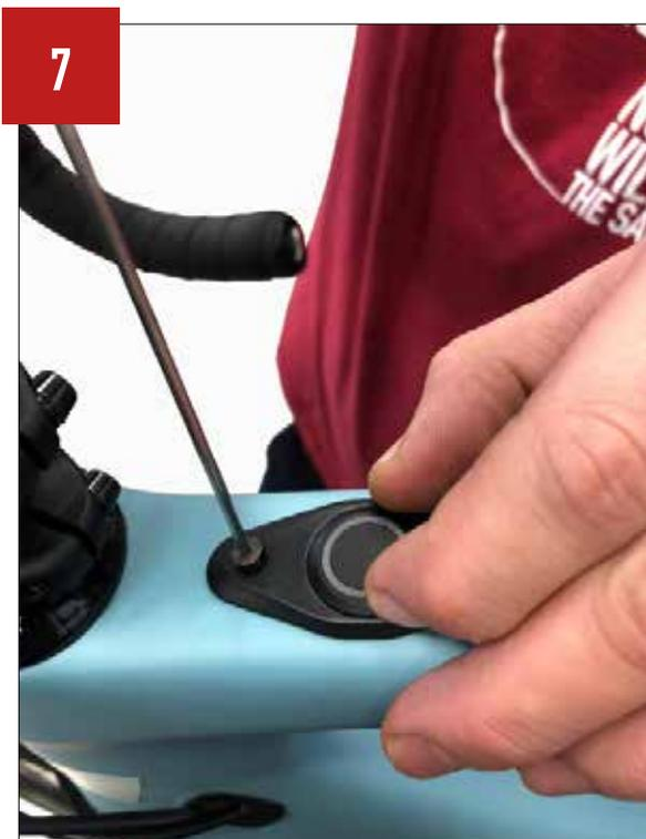
Riposizionare il pulsante iWoc sul tubo orizzontale e fissarlo con la vite di chiusura
