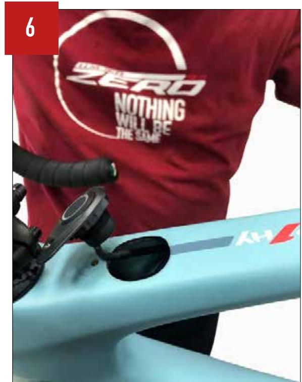
(5+6) Posizionare tutte le connessioni all'interno del tubo orizzontale. Servirsi di materiale plastico per avvolgere le connessioni, in modo da evitare eventuali rumori
