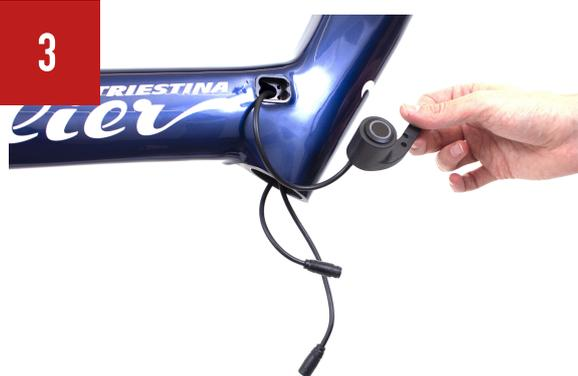
Desconectar los dos cables (batería e iWoc) para que queden sueltos.
