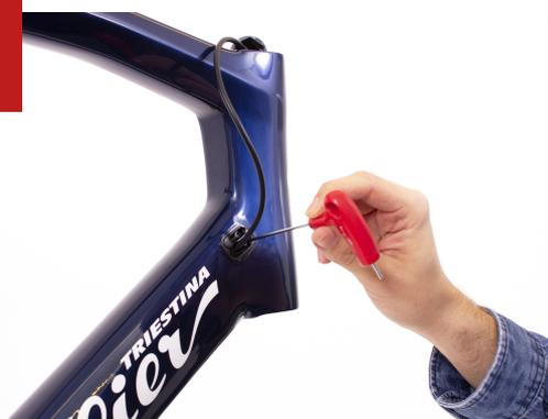
Retirar la horquilla y el manillar del modelo Jena Hybrid para facilitar el posterior montaje. Retirar las placas metálicas de la parte superior del tubo inferior.
