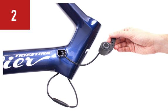
Extraer el cable todavía conectado entre la batería y el botón iWoc del agujero inferior del tubo de dirección.
