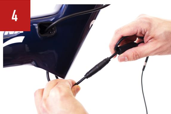
Conectar el cable de la batería al del kit de conversión ANT+
