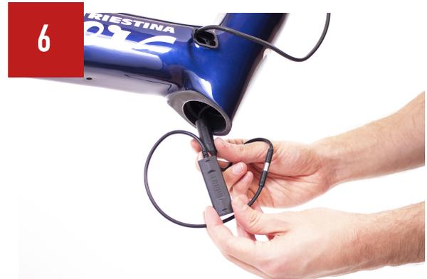
Insérer le kit de conversion ANT+ dans le tube diagonal à travers le trou inférieur du tube de direction.
