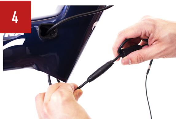
Raccorder le câble de la batterie au câble correspondant du kit de conversion ANT+
