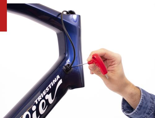
Retirer la fourche et le cintre-guidon de Jena Hybrid afin de faciliter les opérations de montage suivantes.
