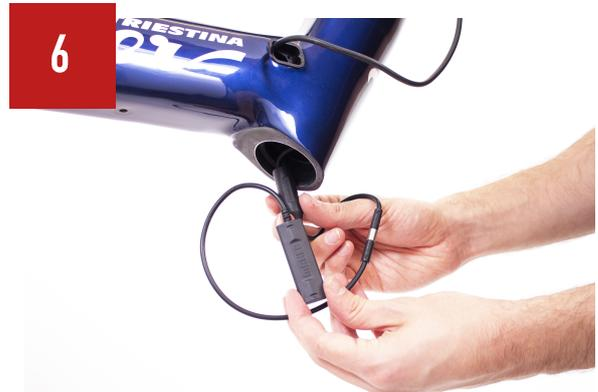
Inserire il kit di conversione ANT+ all'interno del tubo obliquo attraverso il foro inferiore del tubo sterzo.
