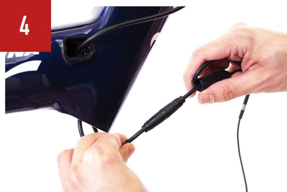
Collegare il cavo della batteria a quello corrispondente del kit di conversione ANT+
