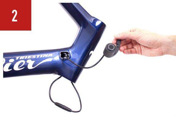
Estrarre dal foro inferiore del tubo sterzo il cavo che collega la batteria al pulsante iWoc ancora collegati tra loro.
