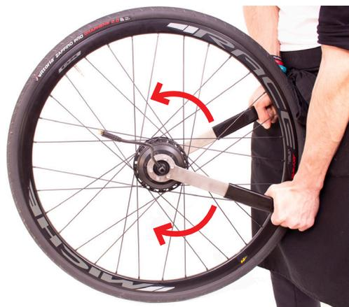
Ruotare le chiavi svitando la flangia esterna del motore.
