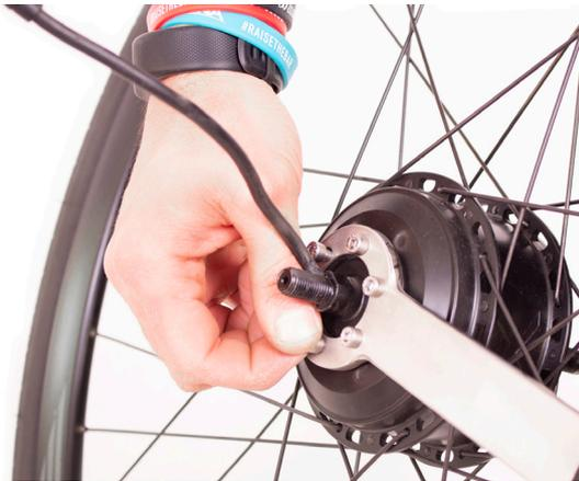
Fissare la chiave di apertura X35 al motore con le sei viti in dotazione verso il lato del rotore.
