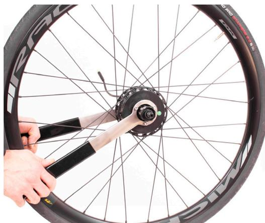
Riposizionare le tre viti al motore nel lato corpo ruota libera.
