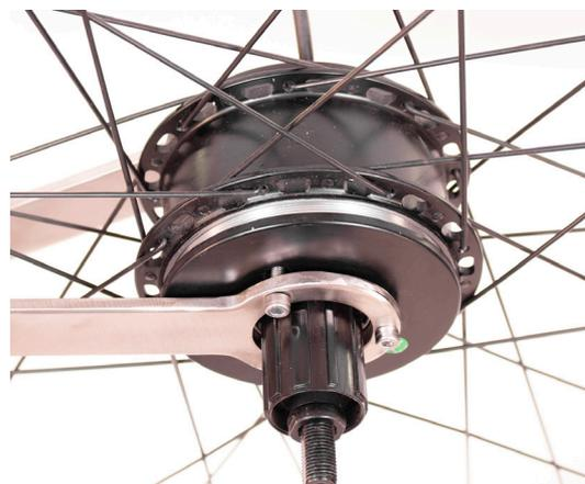
Estrai la parte interna del motore.
