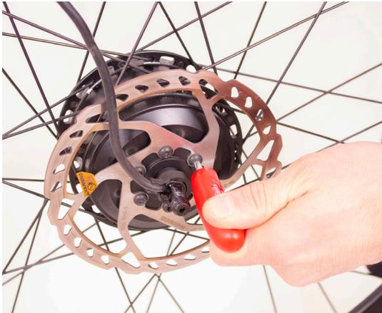
Rimuovere le viti di fissaggio del fisco al motore.
