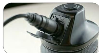
3. Collegare l'altra estremità della GCU alla porta di ricarica del range extender (a questo punto il range extender si accenderà tramite l'azione del caricatore).
