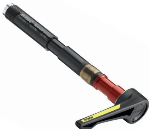
La scelta del perno **Speed Release** è stata fatta anche in ottica di risparmio del peso (solo 85 grammi la coppia) e salvaguardia dell'integrità del telaio: nelle operazioni di serraggio della ruota, al raggiungimento della coppia di serraggio ottimale entra in funzione il sistema integrato di controllo che previene il conferimento di forze extra che potrebbero rovinare il filetto di accoppiamento e quindi il telaio o la forcella.
