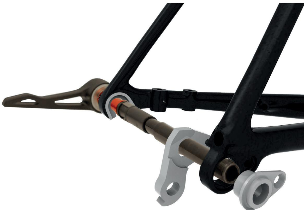
Incorporar el eje Speed Release también sirve para ahorrar peso (tan solo 85 gramos el par) y salvaguardar la integridad del cuadro. Al apretar la rueda, cuando se alcanza el par de apriete óptimo, es cuando entra en funcionamiento el sistema de control integrado, que impide la transmisión de fuerzas adicionales que podrían dañar la rosca y, por lo tanto, el cuadro o la horquilla.
