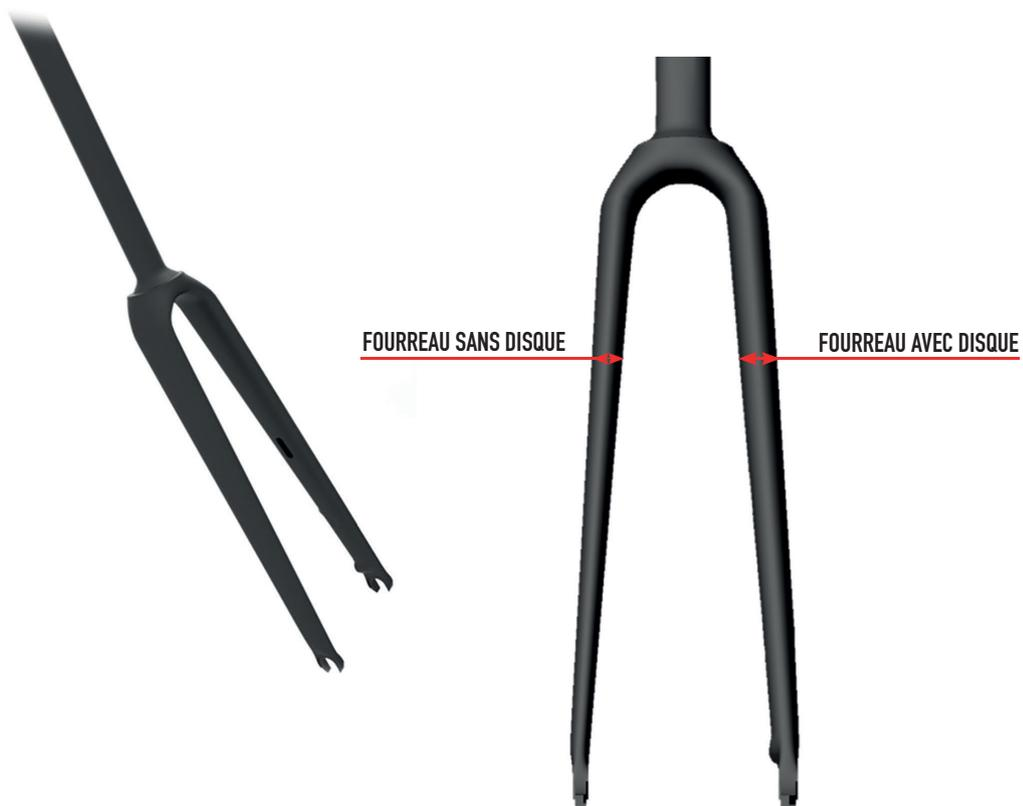
Afin d'améliorer l'aspect aérodynamique, la distance entre les fourreaux de la fourche et de la roue a été augmentée, d'après l'expérience acquise lors du développement du vélo de triathlon et contre-la-montre Wilier Turbine : ainsi, les turbulences contrastantes générées par la roue et le cadre en mouvement diminuent et améliorent la pénétration aérodynamique.
