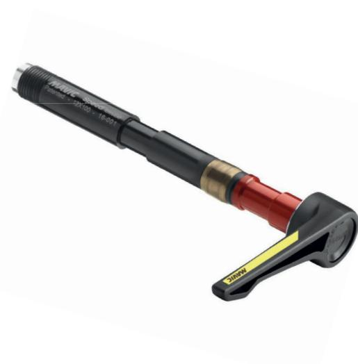
Le choix de l'axe Speed Release a été effectué en vue d'économiser du poids (85 grammes seulement pour la paire) et de garantir l'intégrité du cadre : lors des opérations de serrage de la roue, lorsque le couple de serrage optimal est atteint, le système intégré de contrôle entre en fonction pour prévenir des forces supplémentaires qui pourraient abîmer le filet d'accouplement et donc le cadre ou la fourche.
